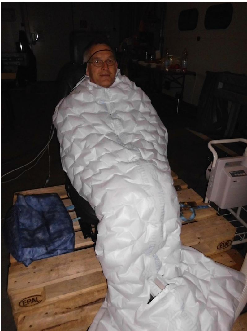
Abbildung 8: Versuchsteil A - konvektiver Luftwärmer. Quelle: A. Lorey-Tews
