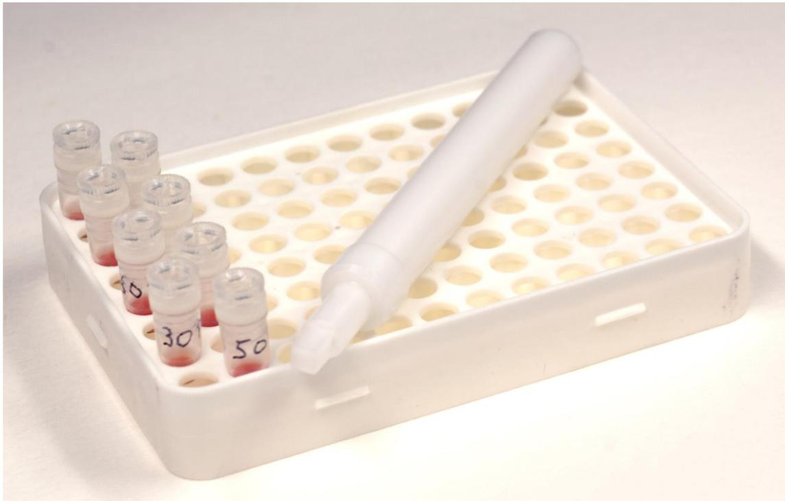
Abbildung 5: Lagerung der Tube-Pellets auf einem Rack mit entwickelter Verschluss-hilfe.
