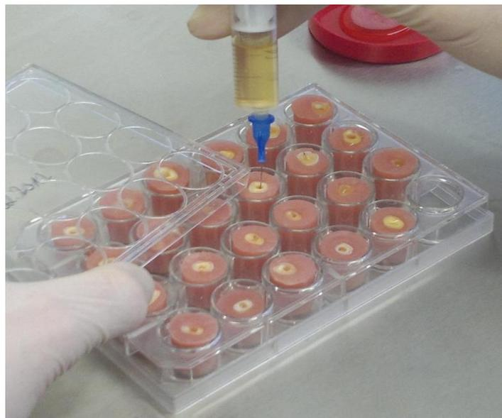
Abbildung 3: Infektion der Prüfkörper mit *E. faecalis*
