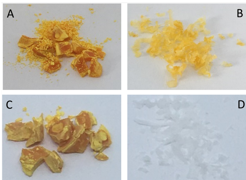
Abb. 3.6. Mit dem anionischen MO beladenes PE vor den Extraktionsexperimenten [oben: PE-N + -MO - (A) und MO@PE (B)] und danach [unten: PE-N + -MO - (C) und MO@PE (D)].
