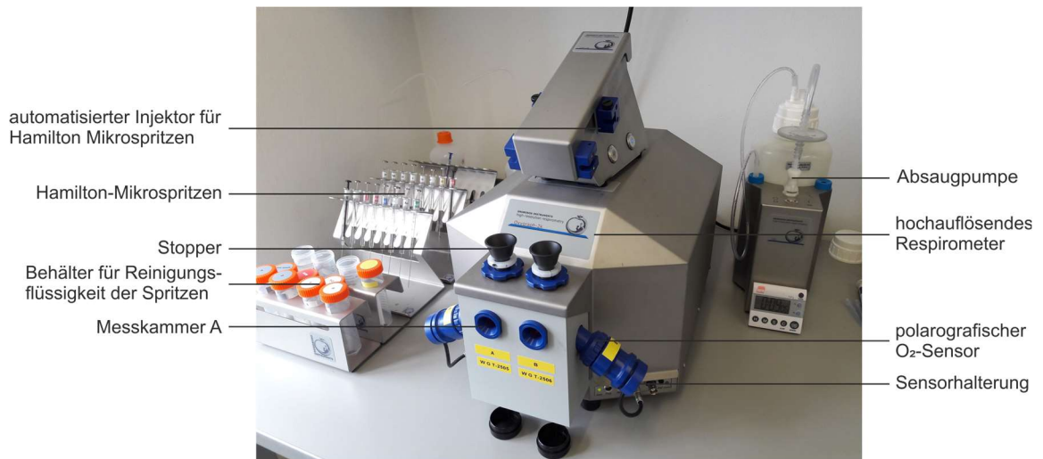
Abbildung 5: Übersicht über den Versuchsaufbau. Zu sehen sind das hochauflösende Respirometer und das für die Messung notwendige Zubehör. Der Oxygraph ist an einen Computer angeschlossen, der in Echtzeit die gemessenen Daten abbildet und die Programmsteuerung des Oxygraphen übernimmt (nicht Teil der Grafik).
