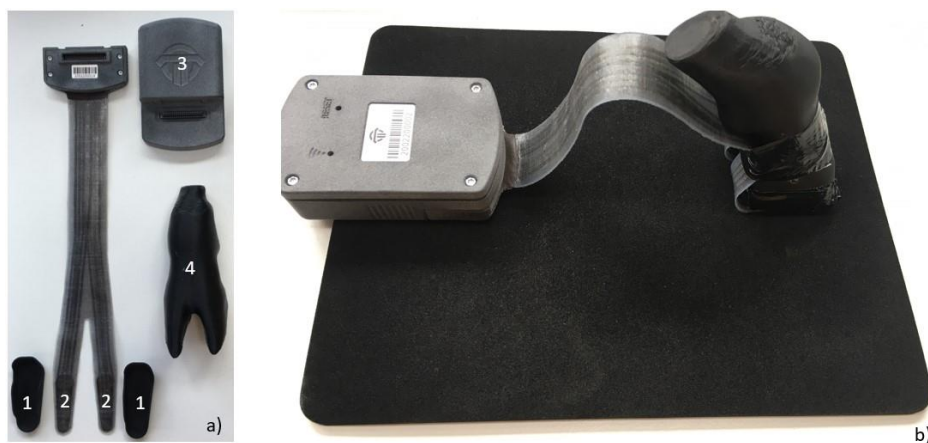
Abbildung 2.2 Material zur Klauendruckmessung. (a) 1 = Messschuhe, 2 = Drucksensor, 3 = WLAN-Modul, 4 = 3D-gedruckte Schafsklaue; b) zusammengesetzte Messvorrichtung auf Schaumstoffunterlage. Die Verwendung der Bilder erfolgt mit freundlicher Genehmigung von Movimento, Orthopädie-&Rehatechnik GmbH, Kassel.
