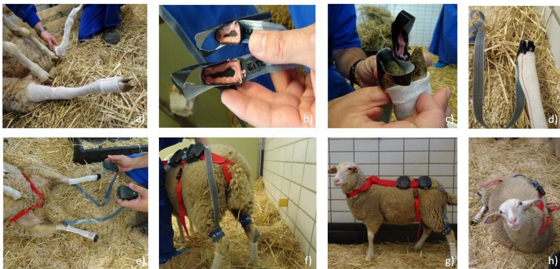
Abbildung 2.3 Vorbereitungen zur Klauendruckmessung mit Schuhsensoren. a) Schaf in Schäferhaltung mit Stretch-Schlauchverband zum Schutz von Bein und Fell an beiden Hinterbeinen; b) Messschuhe, am Rand mit Impresil ausgespritzt für einen formschlüssigen Halt des Schuhs an der Klaue; c) Andrücken des Messschuhs bis zur Aushärtung des Impresil; d) Mit Gewebeklebeband fixierte Messschuhe an Klaue; e) Verbundene WLAN-Module; f) Schaf von hinten mit an den Tibiae befestigten Sensorbändern, welche mit den am Haltegurt angebrachten WLAN-Modulen verbunden sind; g) Schaf mit Haltegurt und Sensoren an Hinterbeinen; h) Schaf mit Haltegurt im Liegen.
