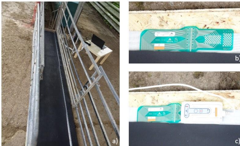
Abbildung 2.5 Material und Versuchsaufbau zur Klauendruckmessung mit Sensormatte. a) Walkway Gangstrecke innerhalb des mit Pferchgittern gelegten Treibgangs, rechts davon Laptop zur Datenerfassung; b) Sensorleitungen der einzelnen Messbereiche; c) Module zur Registrierung der elektrischen Signale und Weiterleitung an die USB-Module.
