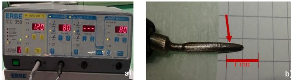
Abbildung 2.10 Material zur Thermoablation. a) Hochfrequenzchirurgiegerät mit den gewählten Einstellungen; b) Elektrodenspitze. Der rote Pfeil markiert die Einkerbung bei 5 mm, bis zu der die Spitze in den Knochen eingeführt wurde.
