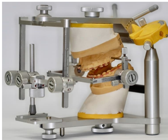
Abbildung 23: MRI im Artikulator Nach der Platzierung des MRI anstelle des Stützstiftes im Artikulator, kann mit Hilfe der drei Messspitzen die Verlagerung von Ober- und Unterkiefer räumlich durchgeführt und vermessen werden. (Eigene Abbildung)
