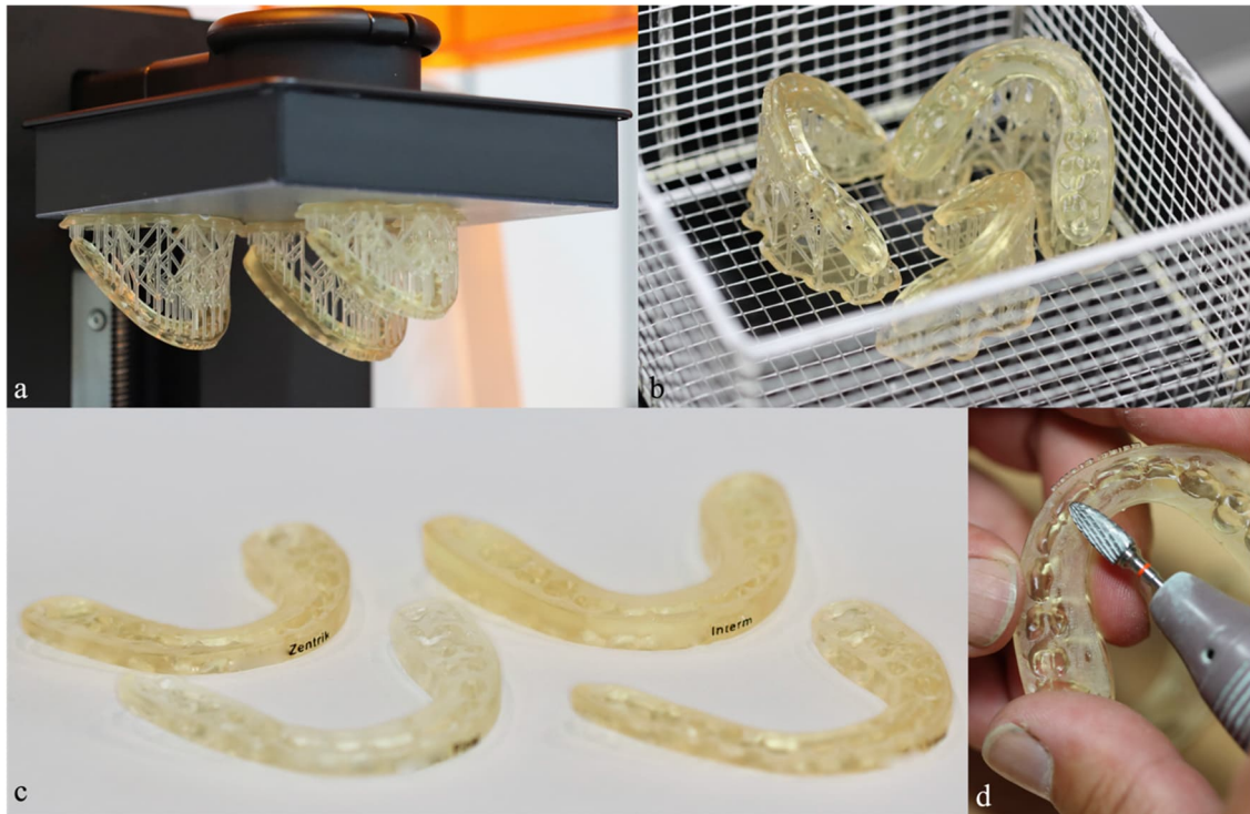
Abbildung 33: Herstellungsprozess der digital erstellten Splinte Nach Abschluss des Druckprozesses (a) wurden die Splinte gesäubert (b) und ausgehärtet. Nach Entfernung der Stützstrukturen (c) konnten die Splinte geglättet und bei Bedarf an den Zahnkranz angepasst werden (d). (Eigene Abbildung)
