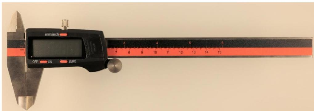
**Abbildung 2: Anthropologischer Gleitzirkel. Werkzeug zum Messen von Dicken und Längen.**
