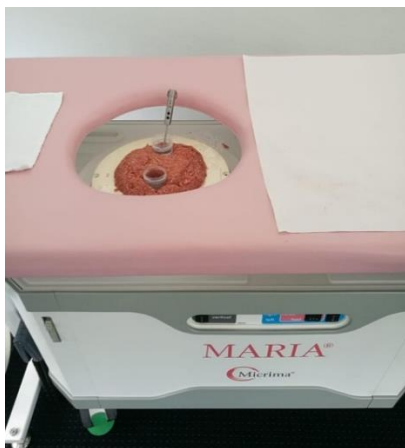
Abbildung 32: Gewebeäquivalentes Phantom mit eingebrachten Flüssigkeitsbehälter und Thermometer zur Frage des Einflusses der Messungen auf die Temperatur sowie zweiter Behälter für die verschiedenen Untersuchungen gefüllt mit Luft, Wasser und Eisenstücken. Phantom innerhalb der Untersuchungseinheit.
