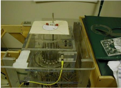
Abbildung 18: Radiowellen-Messgerät mit 14 Antennen (Meaney et al. 2007).
