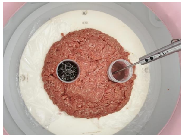
Abbildung 33: Nahaufnahme des gewebeäquivalenten Phantoms innerhalb der Untersuchungseinheit.
