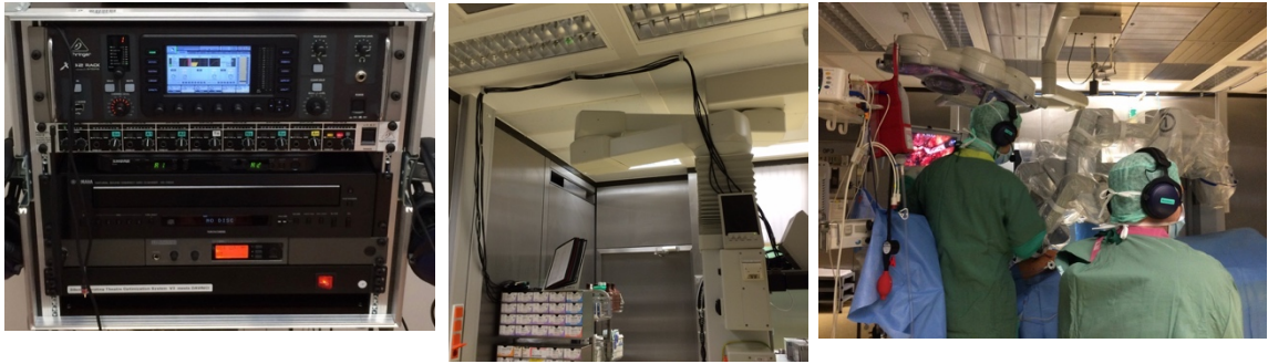
Abbildung 5: SOTOS in der Verwendung im Operationssaal (von links: Steuereinheit, Verkabelung im Operationssaal und Personal mit Verwendung der Kopfhörer/Mikrofonkombination).
