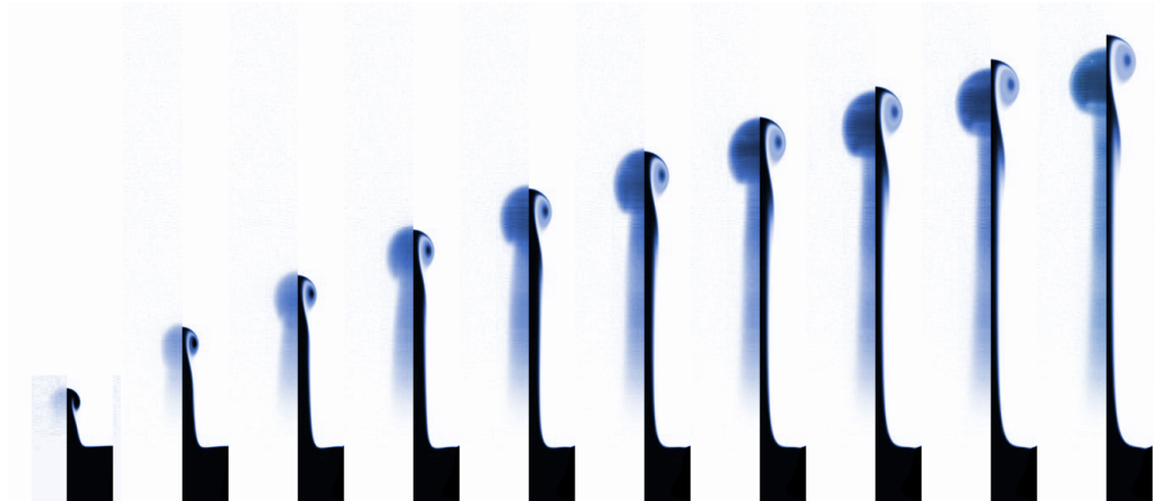
Abb. 4.11.: Vergleich von Simulation (rechts) und Experiment (links) eines Tinten-Pilzes durch akustisch erzeugte Strömung. Die Zeit zwischen zwei Bildern beträgt 0,75 ms. Eine Aufnahme zeigt einen Bereich von 4,12 \times 1,02 \text{ mm}^2 .
