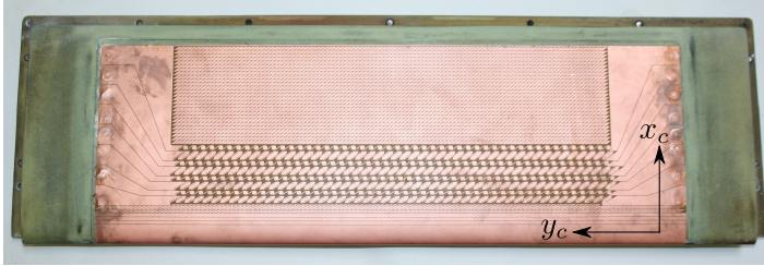
Abbildung 4.5.1: Fotografie der auf dem Heizaktuator-Naseneinsatz fixierten Heizaktuatorfolie vor Auftragen des Epoxid-Füllmaterials
