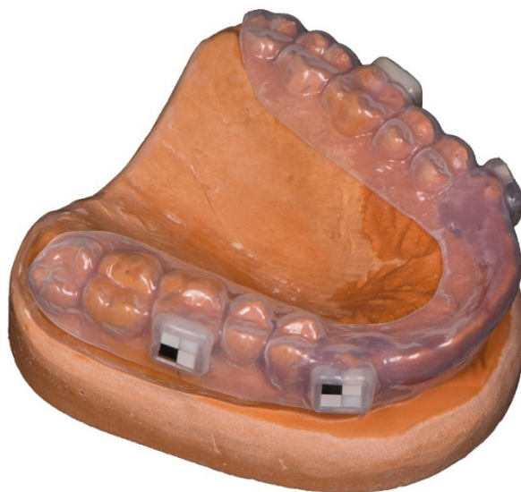
Abbildung 12: Trägerschiene mit Probekörpern auf dem Modell
