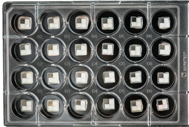
Abbildung 14: 24-Well-Platte mit eingebrachten Probekörpern
