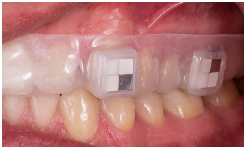
Abbildung 13: Trägerschiene mit Probekörpern in situ
