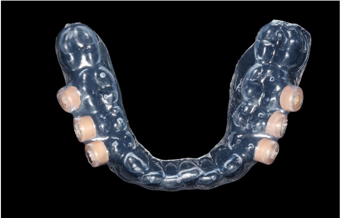
Abbildung 2.3: Schiene mit Prüfkörpern
